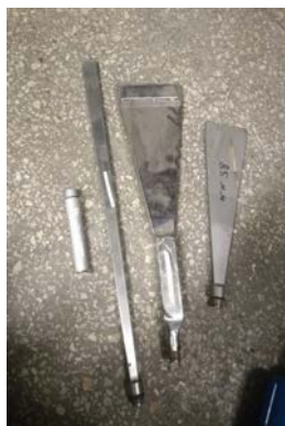
5, 6, 7, 8. Насадка Nozzle wide 85 мм, насадка Nozzle wide 135 мм (2 шт.), насадка Nozzle round 100/15 мм
