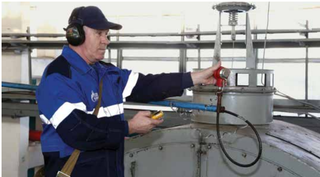
Машинист установки Николай Зубков проводит замер концентрации вредных веществ в машинном зале
