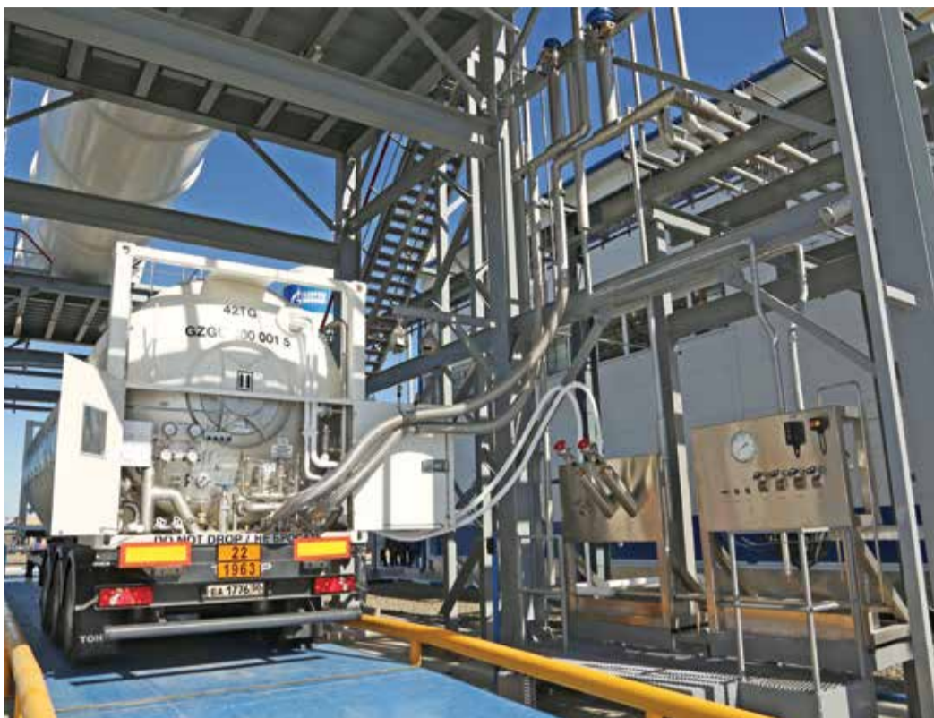
Идет заправка жидким гелием первой цистерны
