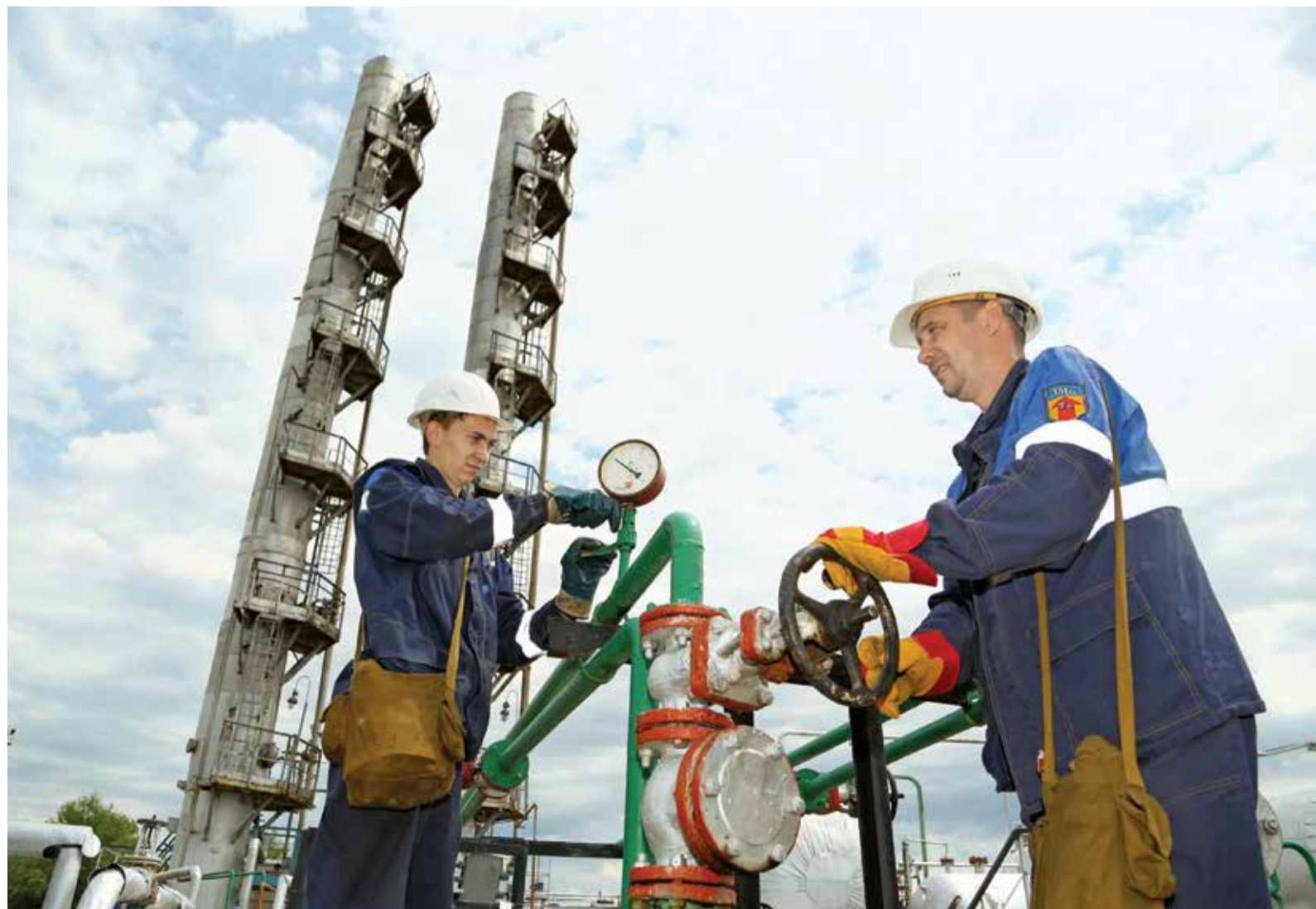
Операторы Фидан Хуснутдинов и Алексей Уткин пускают насос, подающий сырье в колонну регенерации метанола
