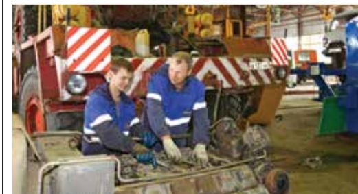
Александр Рубан и Сергей Бабарин демонтируют топливный насос двигателя внутреннего сгорания
