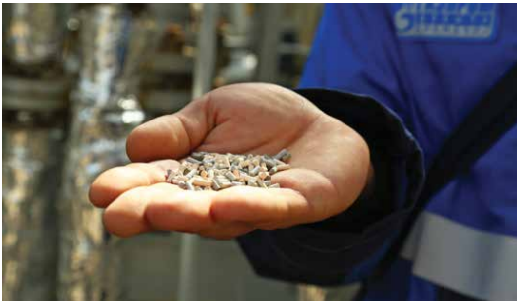
Дорогостоящий реагент используется при очистке природного газа от сернистых соединений
