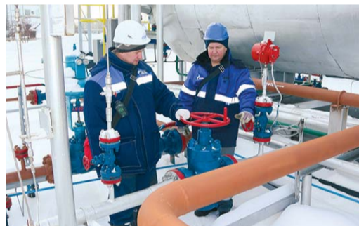
Мастер Виктор Морозов и оператор по добыче нефти, газа и конденсата Владимир Яценко проверяют работоспособность запорной арматуры
