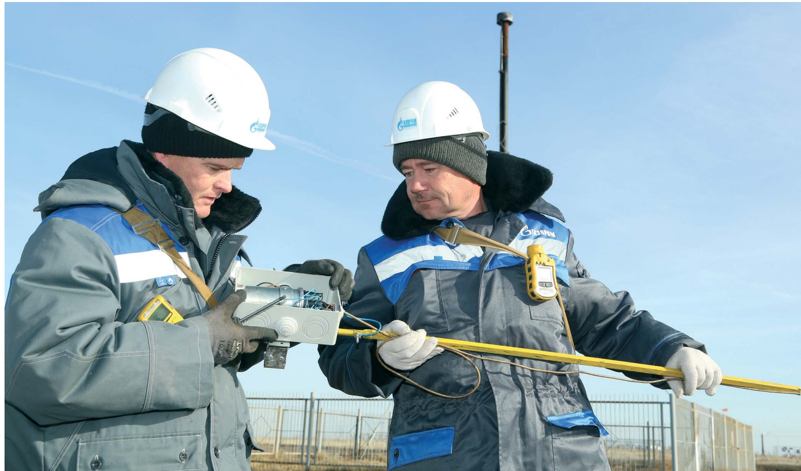
Максим Вавилин и Сергей Татаринов демонстрируют внутреннее устройство блока дистанционного розжига
