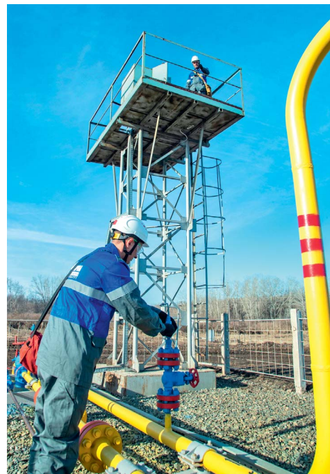
Проверку автоматики безопасности на скважине выполняют операторы по добыче нефти и газа Даниил Жильцов и Максим Хлебников
