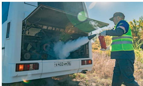
2. Осмотрев механические повреждения автобуса и перекрыв расходные и магистральные вентили подачи компримированного природного газа, водитель обнаружил очаг возгорания в подкапотном пространстве и ликвидировал его с помощью штатных средств пожаротушения.
