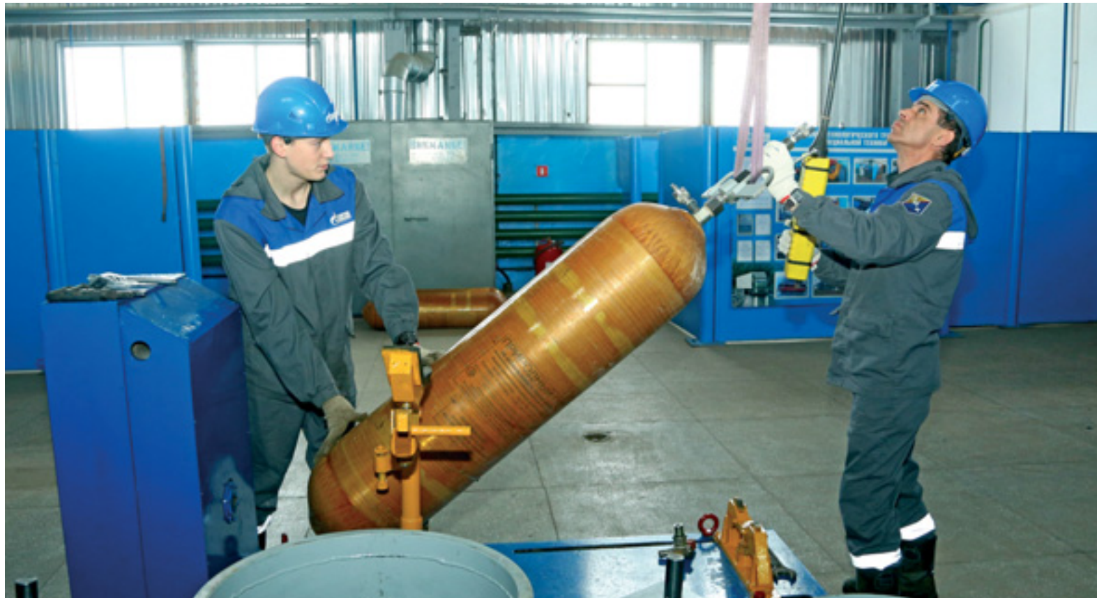
Испытатели Павел Плужников и Сергей Чеканин с помощью кран-балки перемещают баллон в камеру
