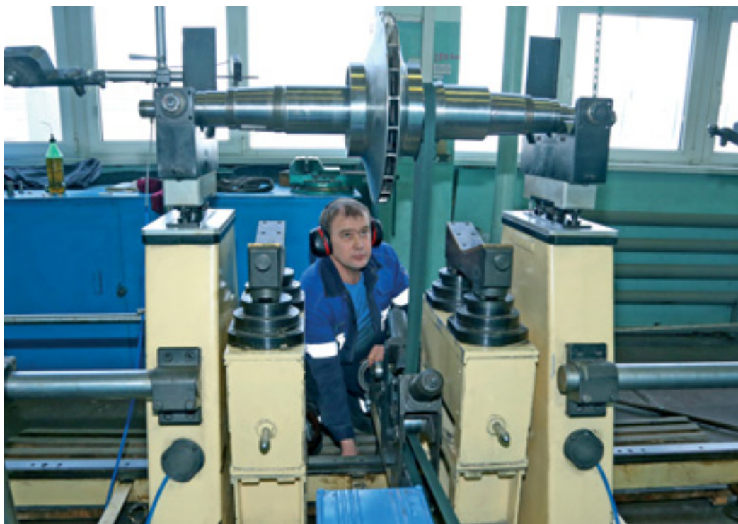
Слесарь-ремонтник Олег Насейкин проводит балансировку ротора турбодетандера
