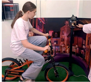
Преобразование механической энергии движений человека в электрическую
