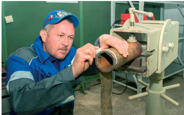
Слесарь по ремонту технологических установок УАВР Рифат Исхаков делает разметку для удаления дефектного участка
