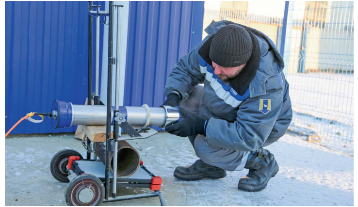
Дефектоскопист ИТЦ Юрий Олисов ведет подготовку к проведению контроля сварного соединения методом цифровой радиографии
