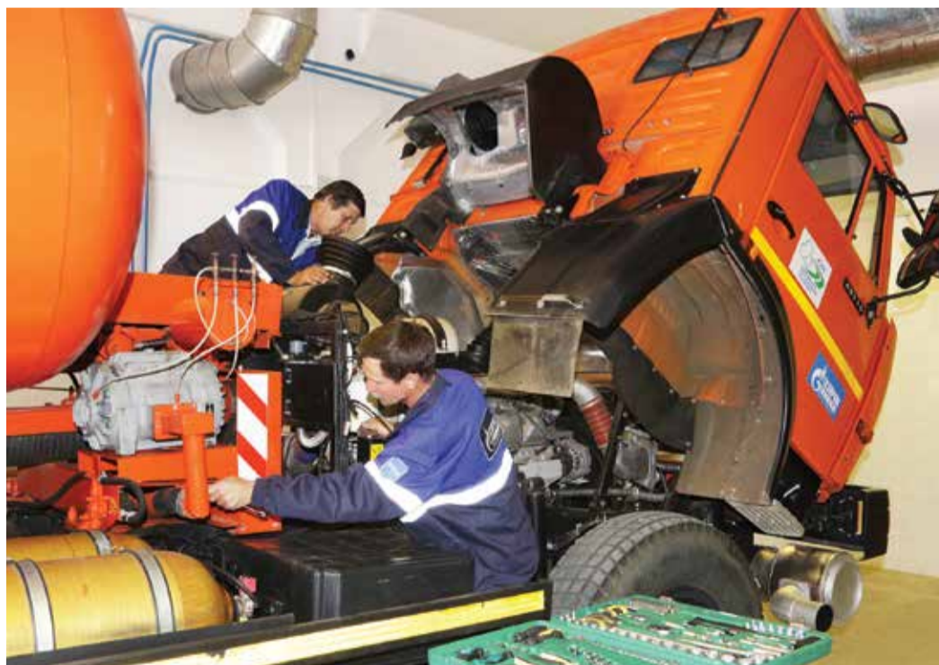
Ведется техническое обслуживание газового оборудования
