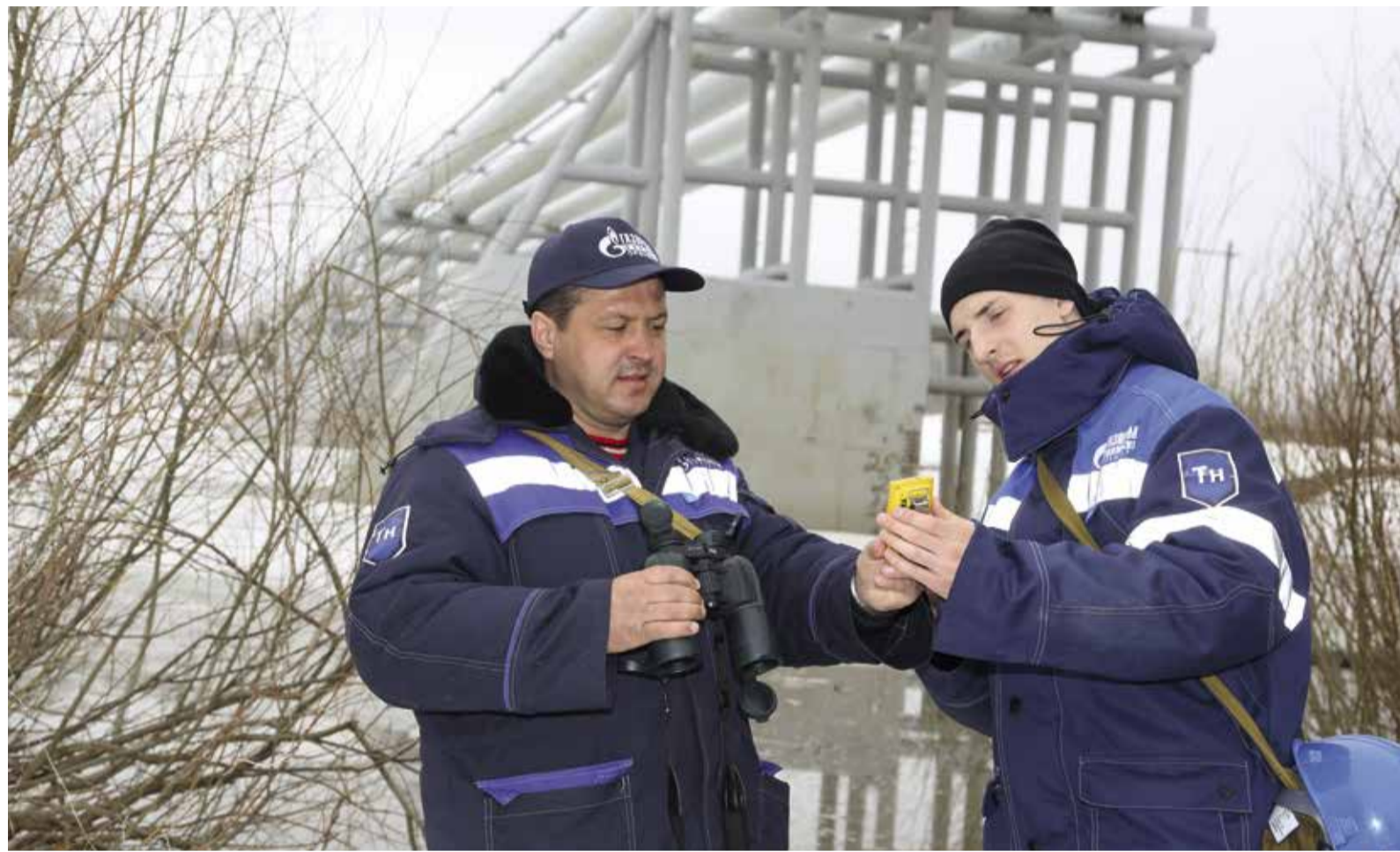
Трубопроводчики линейные Юрий Бердников (слева) и Александр Резвых измеряют уровень загазованности в охранной зоне воздушного перехода
