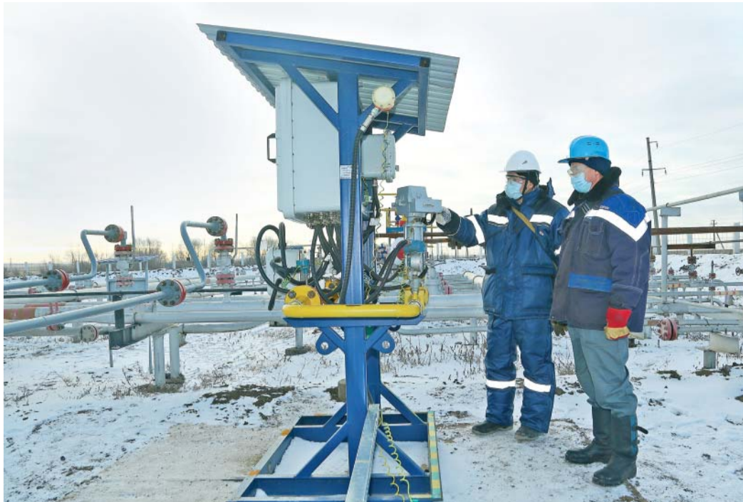
Игорь Кожанов (справа) и Михаил Пикунов выставляют на АСУРГ параметры подачи газа в нефтяную скважину
