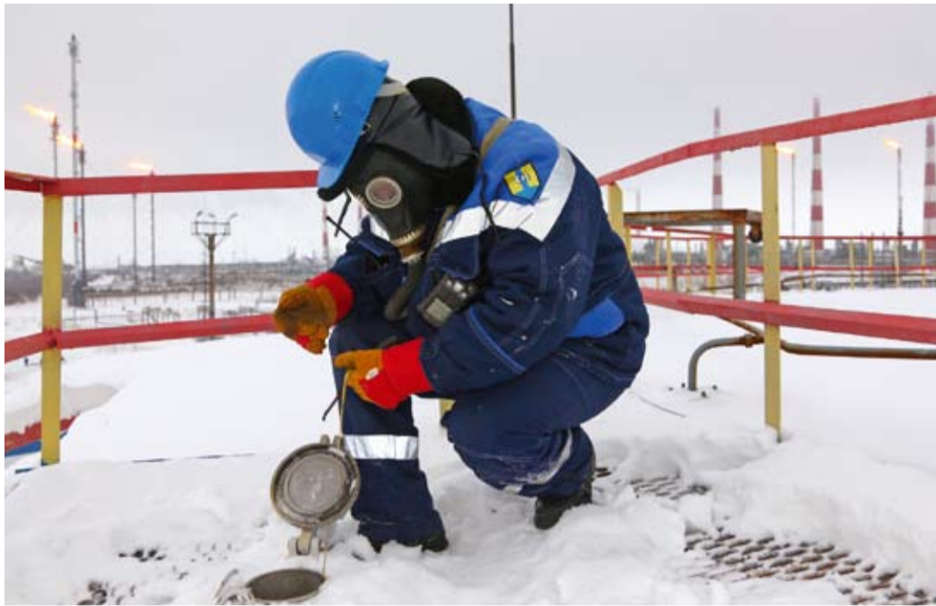
Ведется ручной замер уровня продукта в резервуаре
