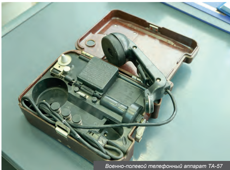
Военно-полевой телефонный аппарат ТА-57
