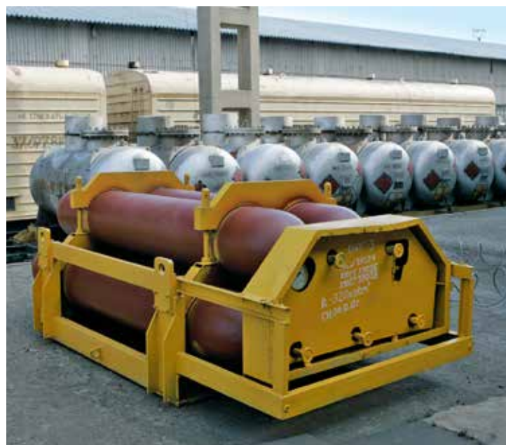
Отправка гелия потребителям железнодорожными контейнерами (на втором плане контейнеры с одорантом)
