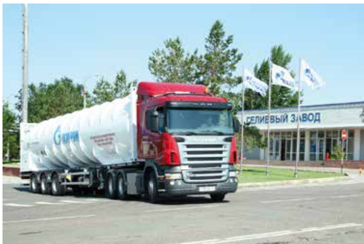
Новая цистерна для транспортировки жидкого гелия
