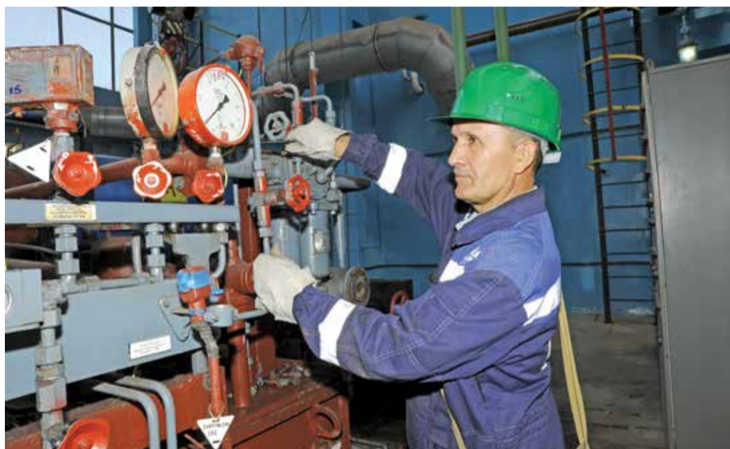
Машинист технологических компрессоров Ринат Иблиев занят разборкой и ревизией маслосистемы газодувки
