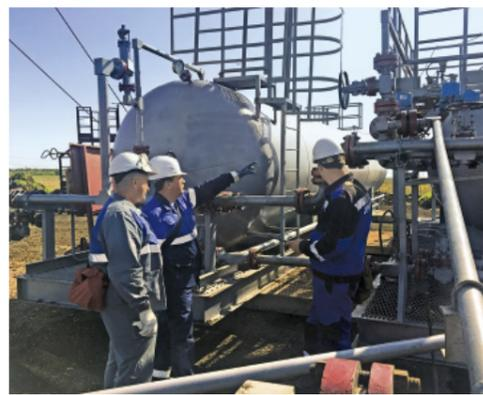
Для исследования скважины смонтирована блочная сепарационная установка
