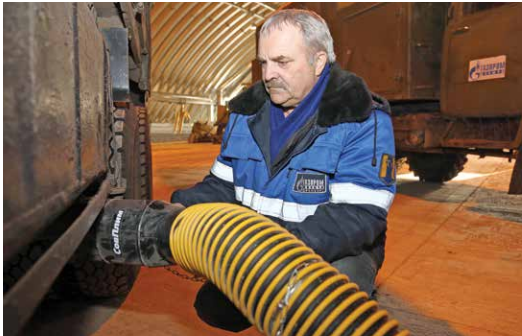
Водитель Юрий Астахов одевает «рукав» вытяжной вентиляции на выхлопную трубу
