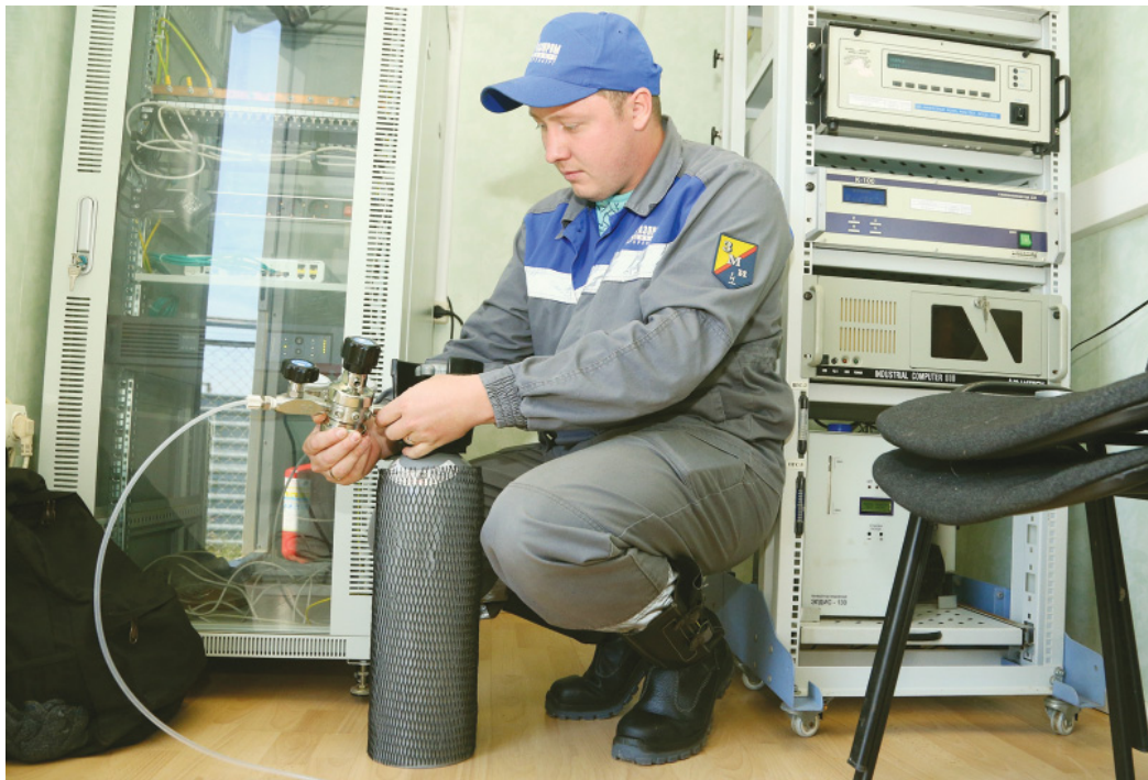
Дмитрий Донсков готовится подключить баллон с поверочной смесью к газоанализатору
