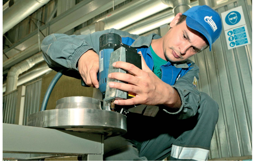
Александр Семинида проводит спектральный анализ стали, из которой изготовлен фланец
