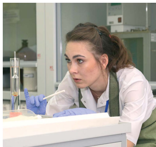
Елена Батурина определяет плотность образца нефтепродукта
