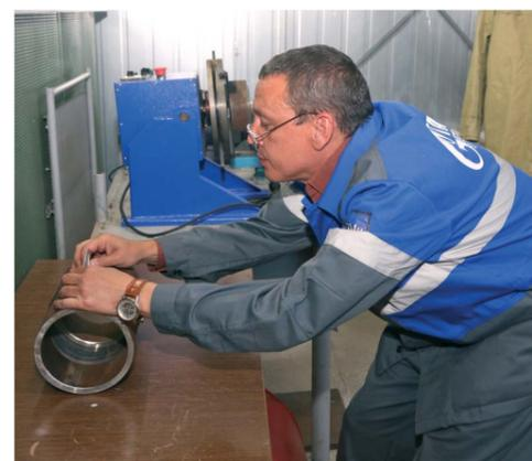
Владимир Немых проводит визуальный и измерительный контроль сварного соединения
