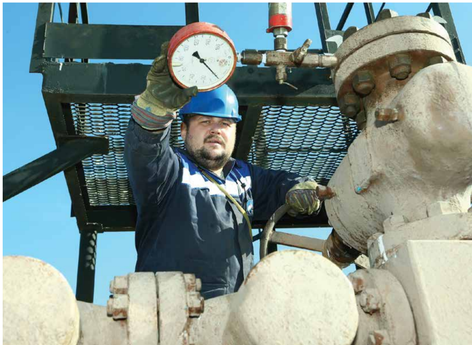
Оператор по исследованию скважин Дмитрий Тырсин устанавливает манометр на исследуемой скважине
