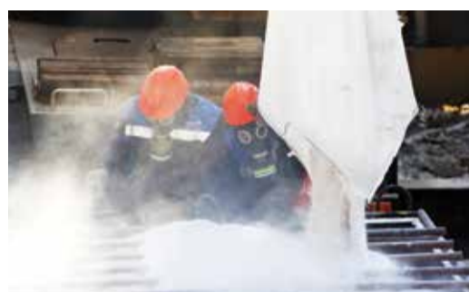
Заполнять контейнер катализатором без противогаза невозможно
