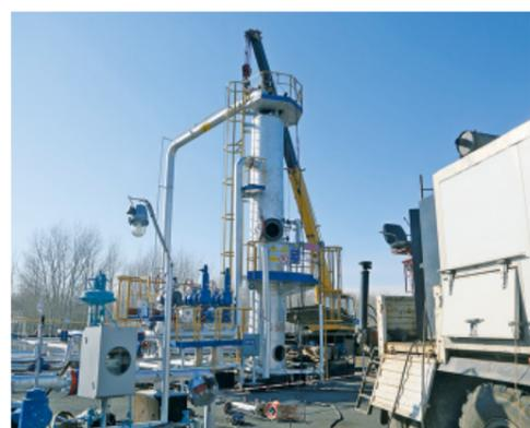
Факельный сепаратор — важное технологическое звено установки комплексной подготовки газа
