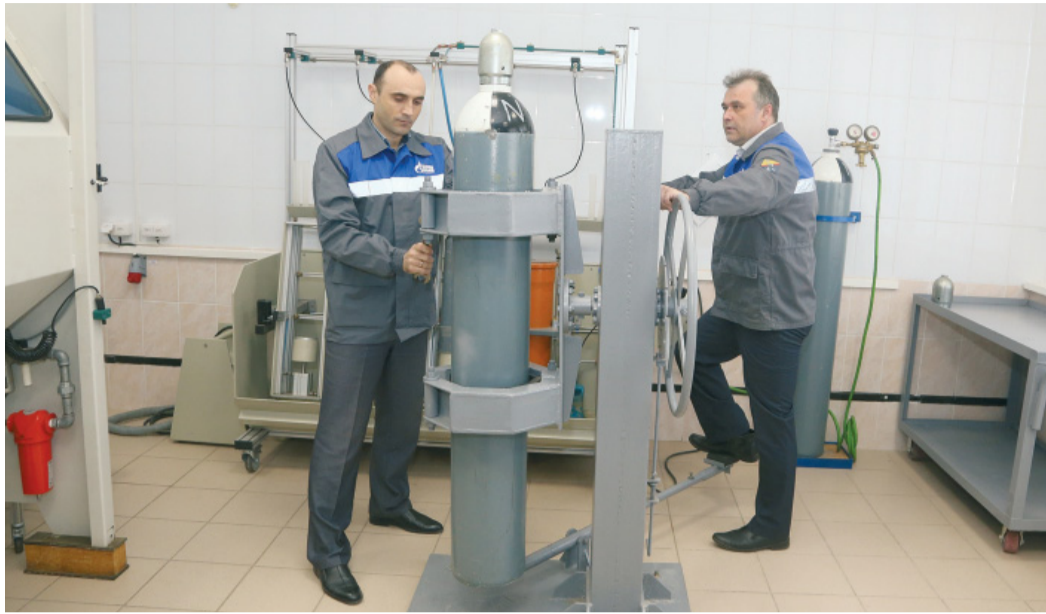
Сергей Новичков и Алексей Силотин проводят гидроиспытание пневмоаккумулятора емкостью 50 литров
