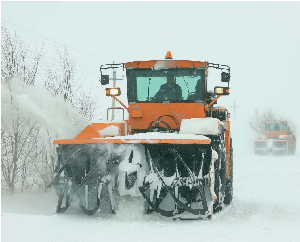
Производительность фрезерно-роторной машины — до полутора тысяч тонн снега в час
