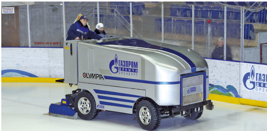
Наставник Петр Десятых поясняет, что оптимальная толщина льда до 7 см: «Большее — хуже застывает, меньше — можно нарушить разметку, расположенную на глубине 2–3 см»
