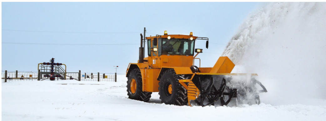
Фрезерно-роторный снегоочиститель прокладывает дорогу до скважины
