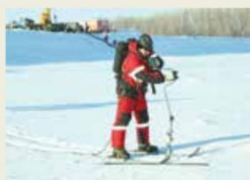
Работа по локализации утечки начинается с ледовой разведки. Вооружившись буром, спасатель на лыжах «прокалывает» лед, чтобы выяснить, не дошел ли разлитый нефтепродукт к данному месту. Разведка показала, что рубеж для установки боновых заграждений выбран верно.
