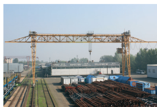
Крупнотоннажный кран способен перемещать грузы до 50 тонн
