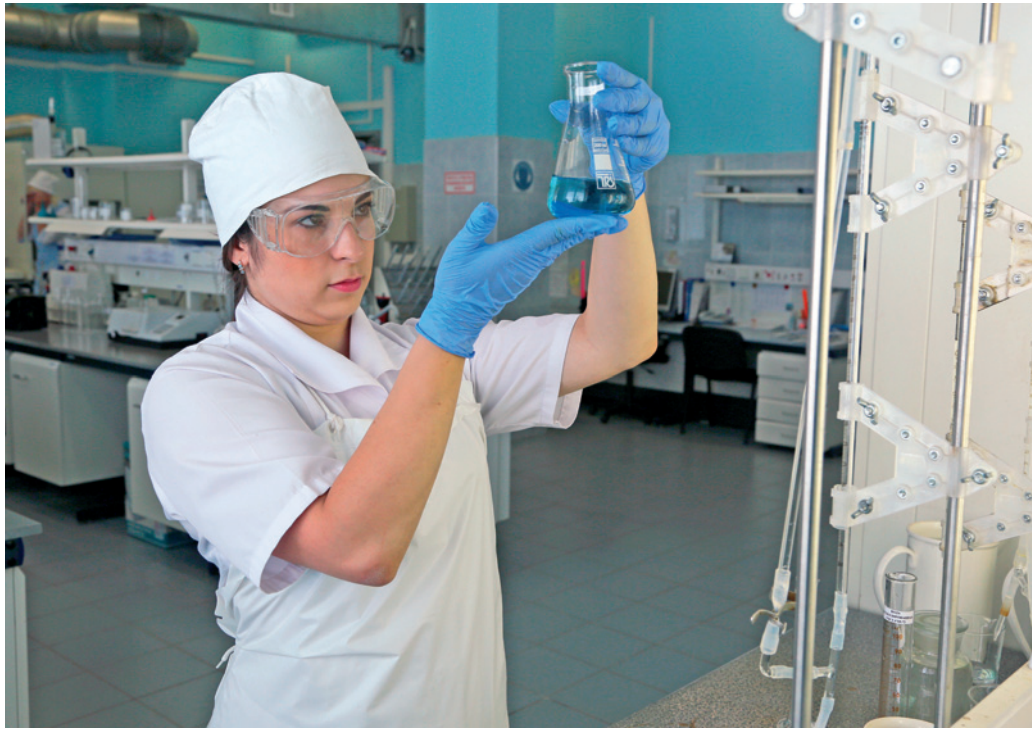
Юлия Лебеденкова выполняет анализ жесткости оборотной воды
