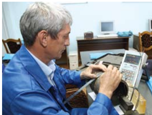
Победитель конкурса дефектоскопистов Азат Янтимиров определяет качество шва
