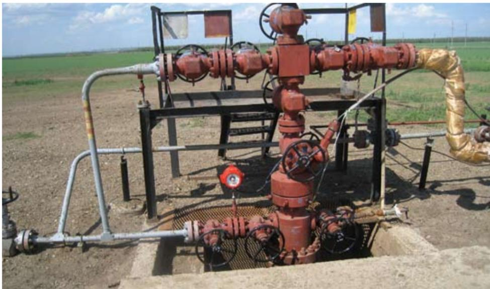
Скважина № 558Н, оснащенная электроцентробежным насосом
