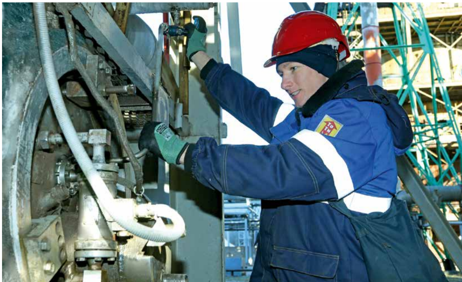
Оператор технологических установок Дмитрий Кольченко подает масло в подшипниковую камеру турбодетандерного агрегата
