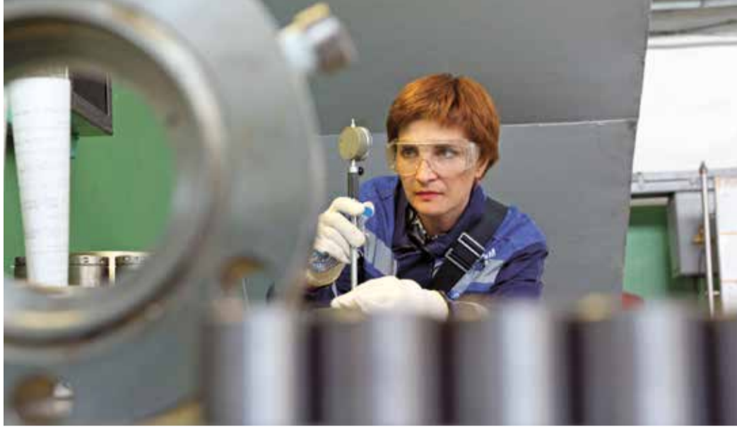
Наталья Полтавец проверяет внутренний диаметр полумуфты с помощью нутромера
