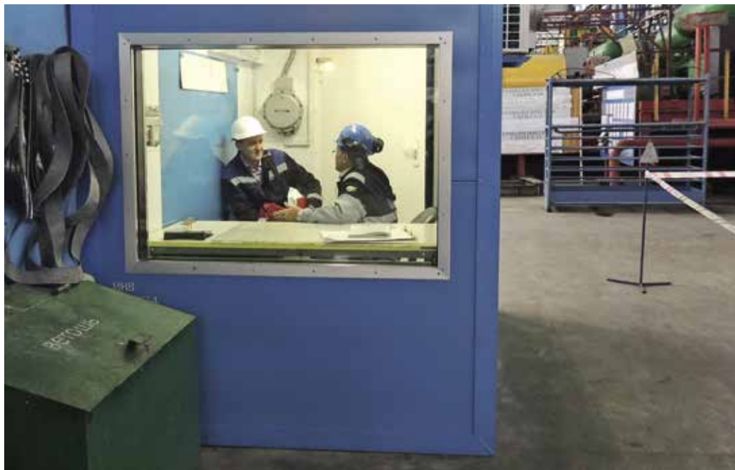
Современные противошумные кабины — сбывшаяся мечта операторов и машинистов
