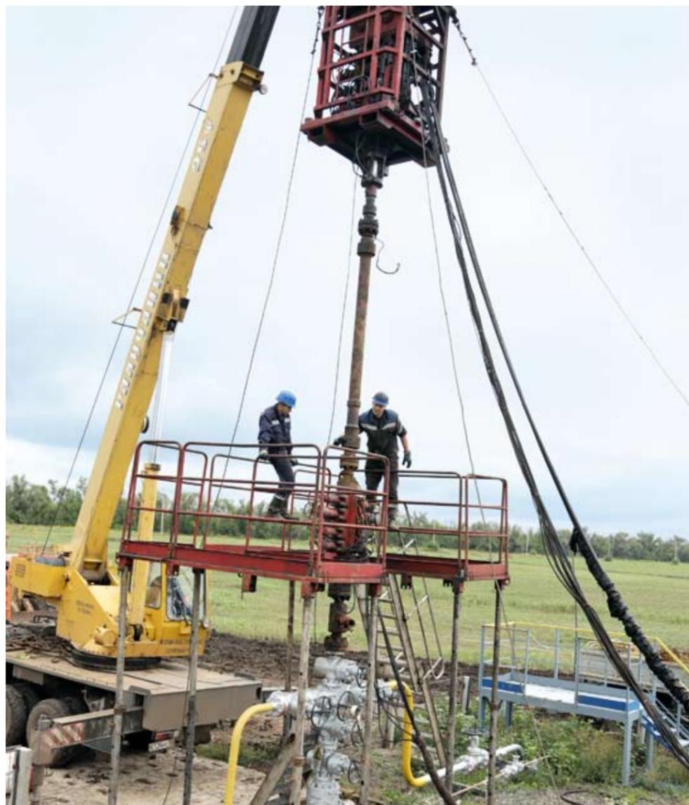
На скважине №10011 проводятся геофизические исследования с помощью колтюбинговой установки
