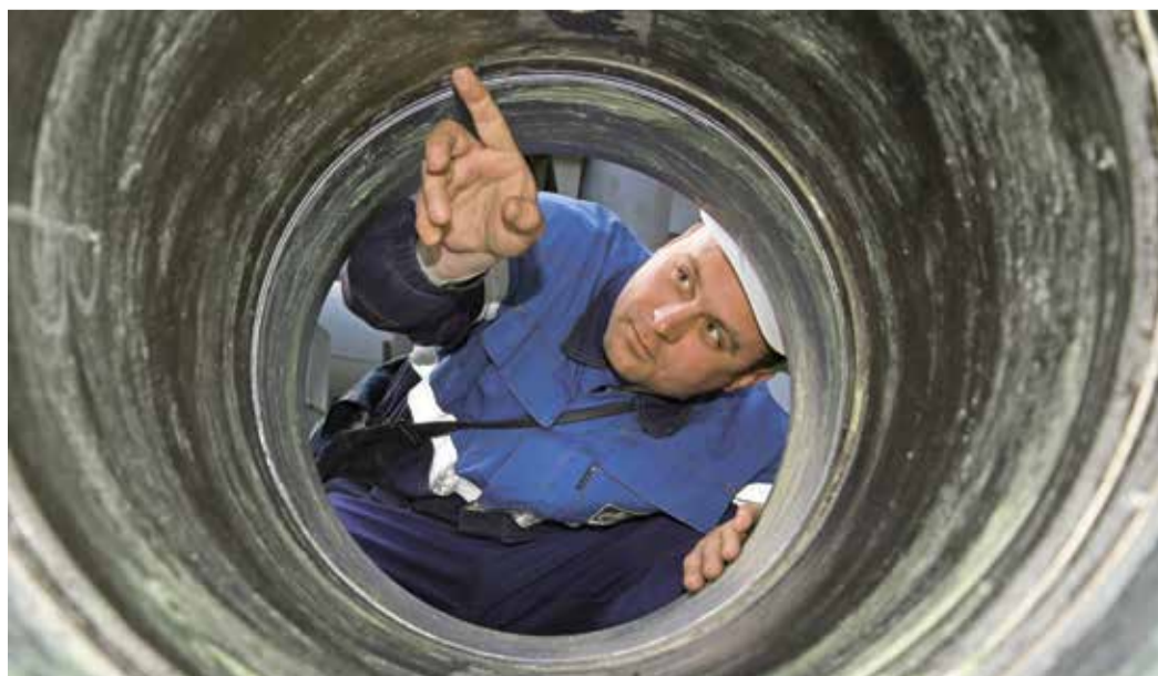
Старший механик цеха Владимир Голозанов осматривает новый шаровый кран
