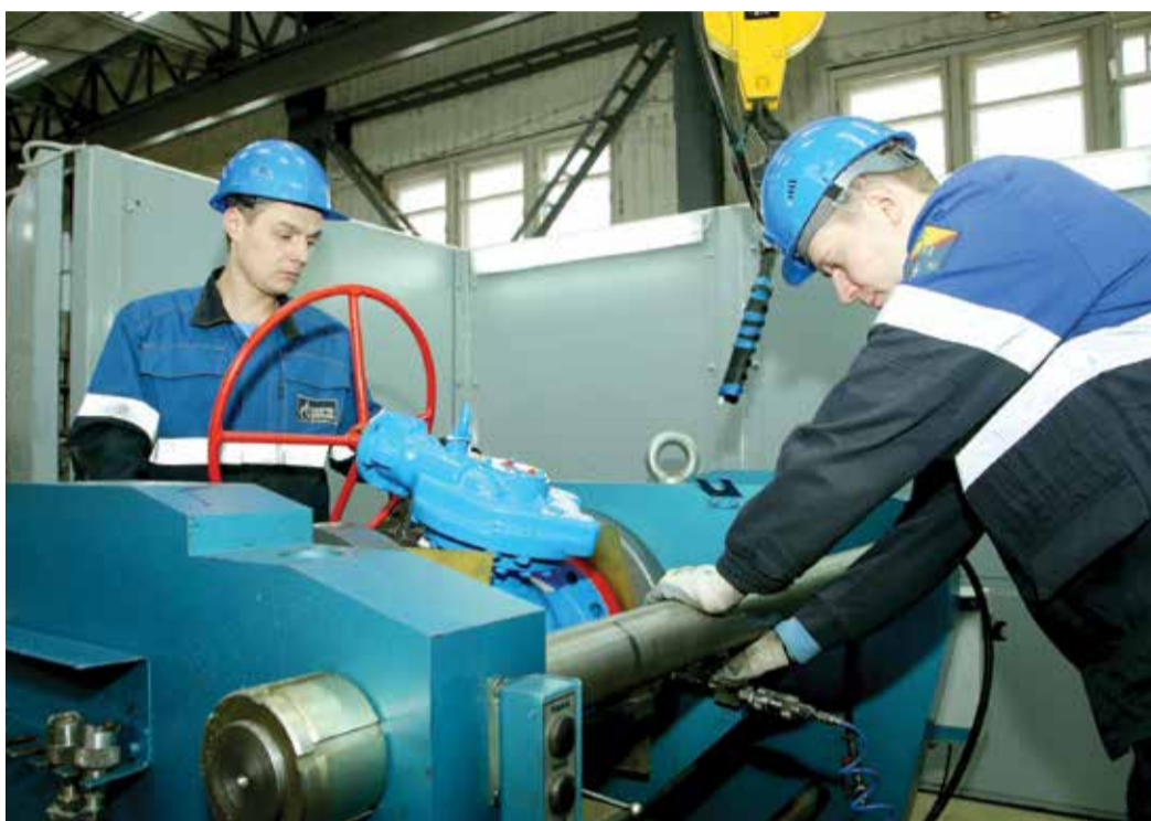
Слесари по ремонту технологического оборудования Александр Князев (слева) и Никита Мужиков монтируют кран для испытания
